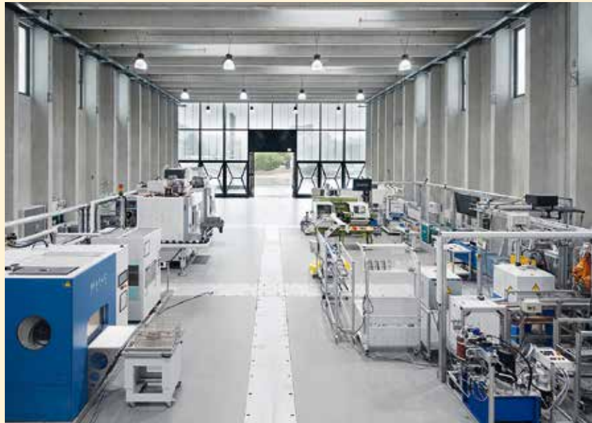
Abb. 1 In der ETA-Fabrik sind die Produktionsmaschinen und das Gebäude energetisch vernetzt; unvermeidlich entstehende Abwärme wird im System weiter genutzt.
